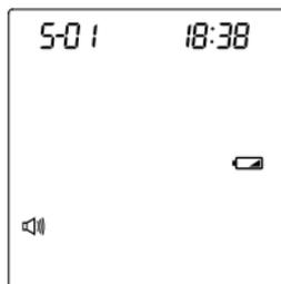
Se l'alimentazione non è sufficiente per eseguire un test, il simbolo
